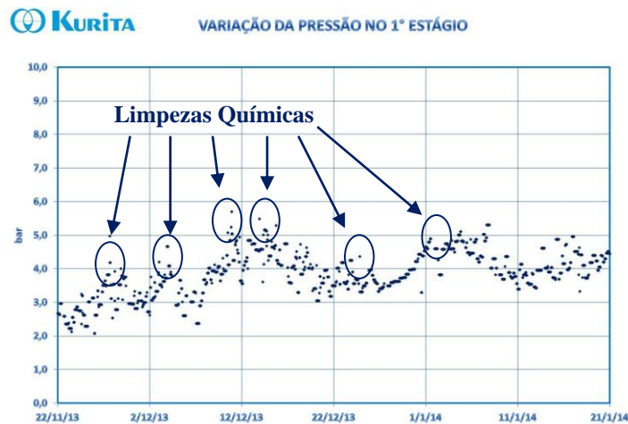
Figura 3: Exemplo Genérico da Variação do Diferencial de Pressão em Sistema de Osmose Reversa.
