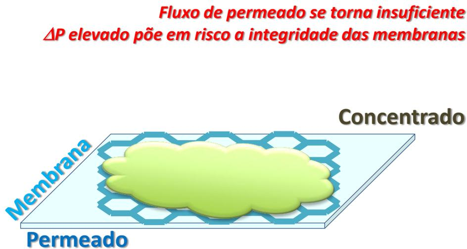
③ Há o desenvolvimento excessivo de colônias orgânicas, entupindo os poros das membranas
