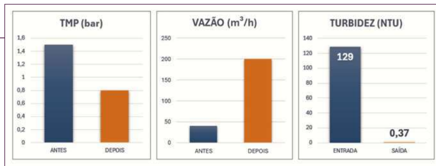
Fig. 4 – Resultados de TMP, vazão e turbidez obtidos antes e depois da limpeza química
